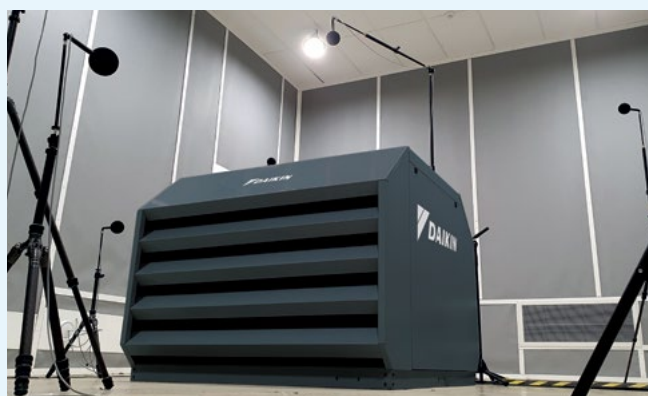
Messung der Schallleistungspegel in einer Akustikkammer
