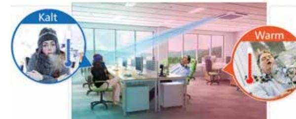
Bei konventionellen Kassettengeräten wird gekühlte Luft über 4 Luftleitlamellen in den Raum eingeblasen. Das führt zu einer ungleichmäßigen Durchkühlung des Raumes und zu einem differenzierten Temperaturempfinden. Personen, die dem direkten Luftstrom ausgesetzt sind, empfinden es als zugig und zu kalt - andere als zu warm. Die Raumzonen über Eck werden kaum vom Kaltluftstrom erfasst.
